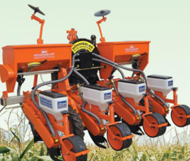
**ASPIRATÖR Max** (500 U/min'de) 130 m bar emiş gücünü sessiz olarak sağlayacak şekilde imal edilmiştir. Düşük motor devrinde yüksek emiş gücü sağlayarak yakıt tasarrufu sağlar. Çok iri tohumları rahat eker. Hava çıkış yönü arkaya doğru imal edildiğinden toz ilaçlama yapılan tohumların ekiminde ilacın sürücüye zarar vermemesini sağlar.
