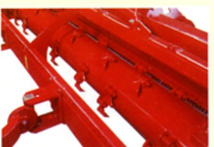
Tek ve büyük rotor kullanılmasının nedeni, çok güçlü bir aspirasyon sağlayarak, tarla içinde sağa-sola serilmiş olan ve traktör tekerlerinin bastırıldığı sapları da yerden kaldırarak parçalanmamış metaryel ile birlikte orta tarafa taşıyarak, daha iyi parçalamasıdır.
